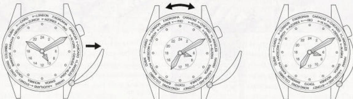
Die Timezoner, die erste tiefgreifende Weiterentwicklung des Konzepts von Louis Cottier: Nach dem Auskuppeln mit dem Hebel kann die gewünschte Stadt auf der Drehlunette von Hand auf 12 ausgerichtet werden. Nach dem Schließen des Hebels rückt der Stundenzeiger automatisch auf die dortige Lokalzeit, ebenso der Zeiger der zentralen 24-Stunden-Anzeige.
