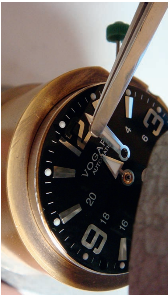
Vogard macht viele Fertigungsschritte im eigenen Haus, unter anderem das Setzen der Zeiger.
